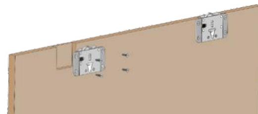
7.1. Зафиксируйте ролик в нижнем положении
